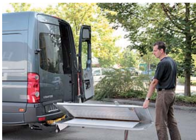
Ручная раскладка – ремённое соединение обеспечивает абсолютно ровную плоскость платформы, без выступов.
