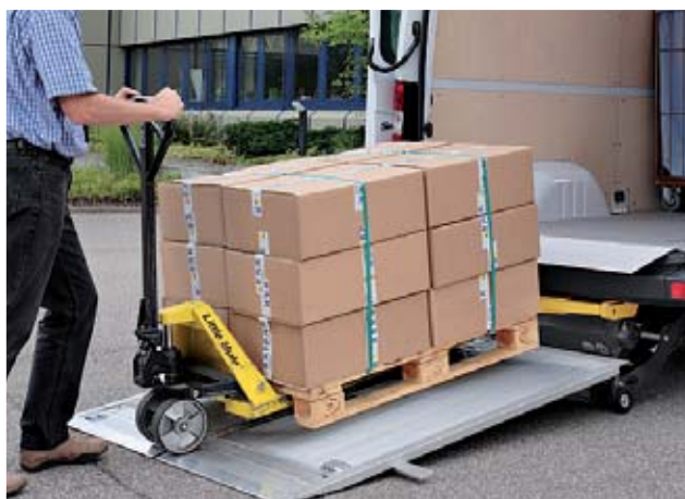
Достаточно места как для для европаллеты так и для роклы. Очень низкий угол подъёма (6,2°). Принимать во внимание вес паллеты. Безопасность работы на платформе с TragGrip и SideGrip.
