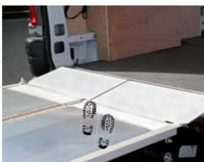
Разделенный мостик VanBridge соединяет пол грузового отсека и платформу. Безопасность работы на платформе с TragGrip и SideGrip.
