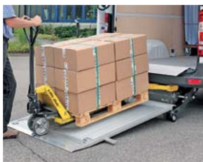
Достаточно места для европаллеты и роклы. Очень плоский угол (6,2 °). Соблюдайте допустимую нагрузку.
