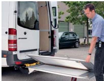
Гидравлически открывается и раскладывается от руки.
