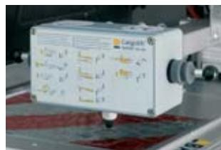
Управление двумя руками с помощью прочных рычажных переключателей.
