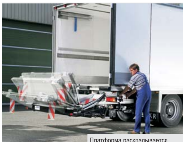
Платформа раскладывается гидравлически.
