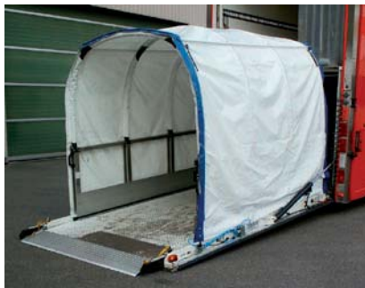
В положении погрузки и разгрузки. Гидравлически опускаемый мост. Платформенные опоры опущены.
