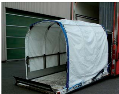
Гидравлически разложенный мост обеспечивает также защиту от скатывания. Платформенные опоры
