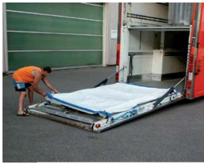
После сборки, тенд закрепляется в 4-х углах стяжными резиновыми ремнями.
